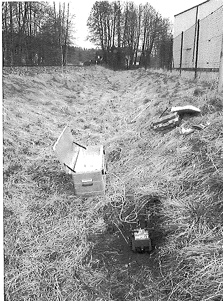
Abbildung 3: Platzierung des Schwingungsmesssystems bei MP1 (Blickrichtung nach Süden)
